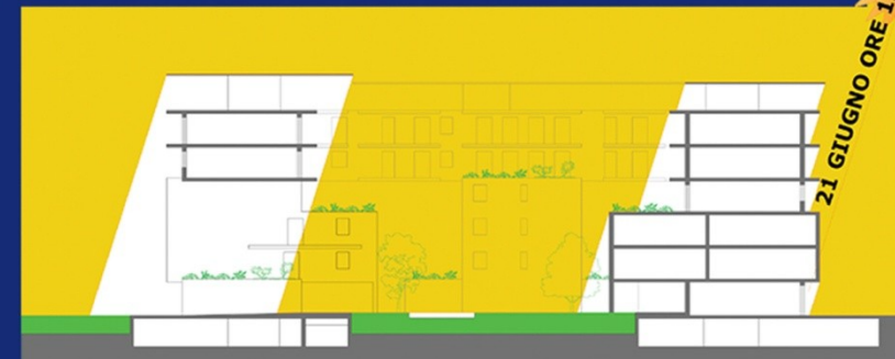
Schemi del soleggiamento dell'edificio a corte
