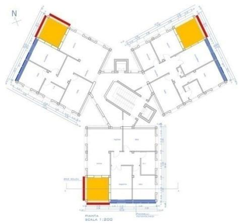
Caratteri costruttivi: struttura in c.a., murature di tamponamento prefabbricate, copertura piana
