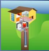
La quantificazione dell'energia potenzialmente estraibile dal sottosuolo con l'ausilio di sonde geotermiche verticali è valutabile prendendo in considerazione la conducibilità termica dei terreni attraversati.
