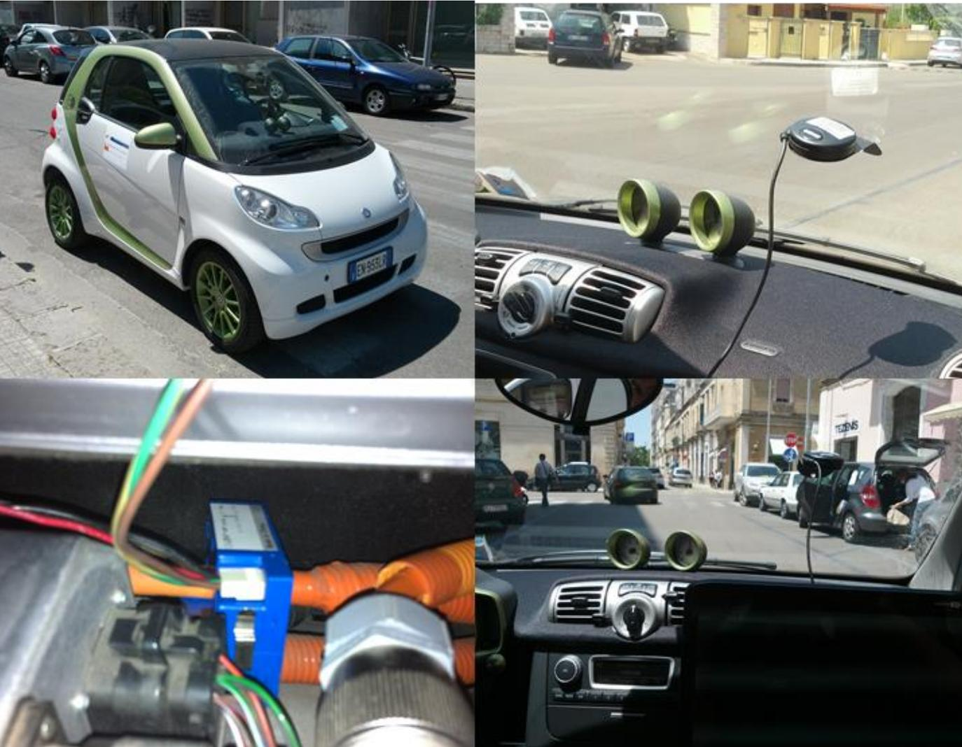
Sistema on-board di acquisizione e trasmissione dati:
