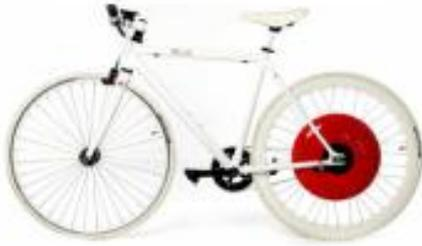
**GREEN Wheel** trasforma qualsiasi bicicletta in una e-bike a pedalata assistita. Tutto il sistema è integrato nella ruota posteriore e il sistema può essere controllato tramite smartphone (es. iPhone®).
