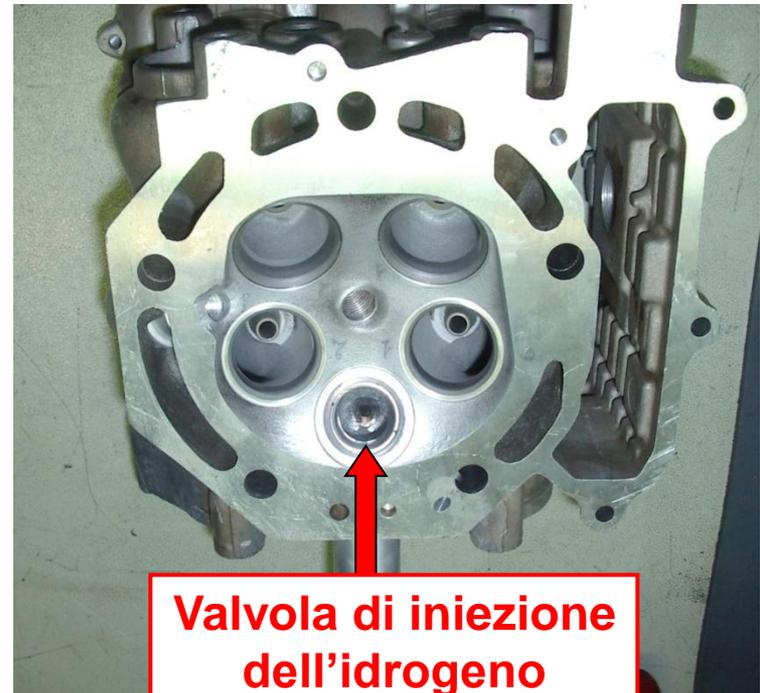
**Valvola di iniezione dell'idrogeno**
